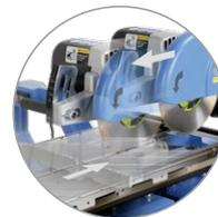
Innovatives Teleskop-System ermöglicht große Schnittlängen
