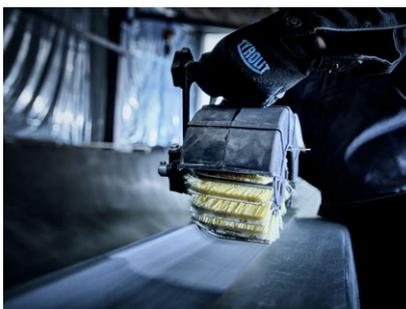
**Tyrolit Power** hat die Feinbearbeitung harter Oberflächen revolutioniert. Die aus Kaktushaar- und Diamantschichten bestehenden Schleifmittel-Strips zeichnen sich durch extreme Härte aus, sparen Zeit und erzeugen deutlich weniger Vibrationen bei der Anwendung.
