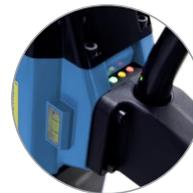
Leistungs- und Serviceanzeige sowie Nivellierhilfe für einfaches Arbeiten
