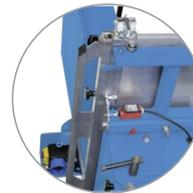
Automatische Sägebandabschaltung gewährleistet keine überflüssige Sägebandbelastung
