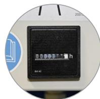
Compteur d'heures de fonctionnement intégré situé au centre et facile à lire
