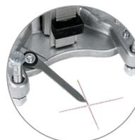
Installation efficace du bâti de carottage grâce à l'indicateur de centrage de série
