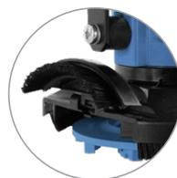
Capot de protection relevable pour les travaux de rectification directement jusqu'à l'arête
