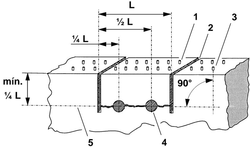
Fig. 4-4 Posición correcta con dos herramientas de compresión
