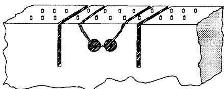
Fig. 4-8 Herramientas de compresión demasiado cerca entre sí
