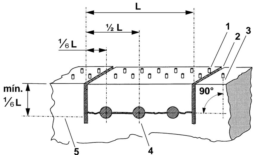
Fig. 4-5 Posición correcta con tres herramientas de compresión
