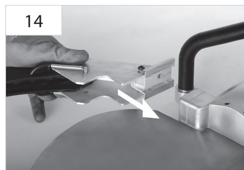
Atornillar ligeramente a mano la protección de estribo.
