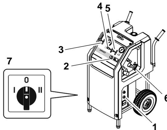
Fig. 5-3 Arranque del Grupo de accionamiento PPH25\*\*
