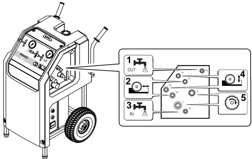
Fig. 5-1 Conexiones de tubo flexible
